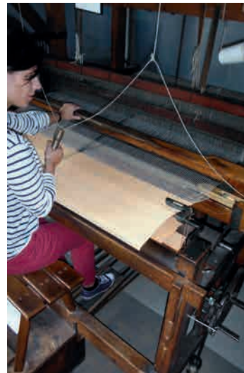
Handwebstuhl Das Weben (= rechtwinkliges Verkreuzen von Fäden) erfolgt in drei Schritten: 1. Bilden des Fachs 2. Eintrag des Schussfadens 3. Anschlagen des Fadens mit dem Kamm/Ried
