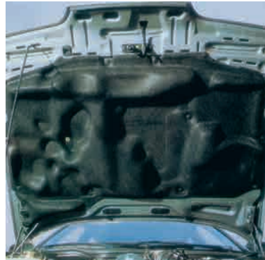
Isolierung der Motorhaube
