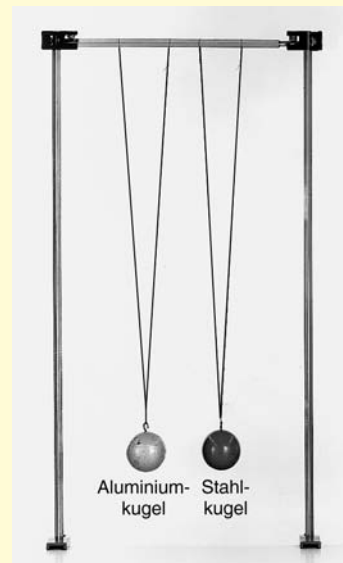
Abb. 1 Schwingungsdauer und Masse bei einem Fadenpendel
