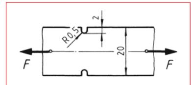
**Bild 2** Flachstab mit Außenkerbe
