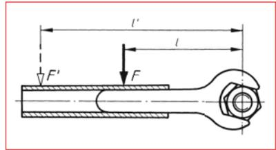
Bild 2 Gabelschlüssel mit aufgestecktem Rohr zur Erzeugung einer großen Drehwirkung
