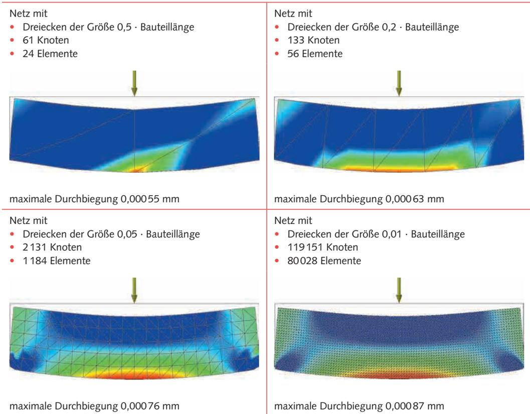
**Bild 1** Auswirkung verschieden genauer Vernetzungen auf den Rechenaufwand und die Genauigkeit der Ergebnisse
