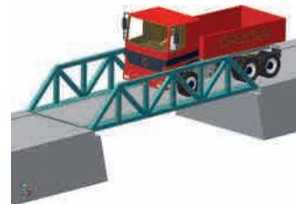
Brücke mit beidseitigen Auflagern und Lkw-Rahmen mit Vorder- und Hinterachse
