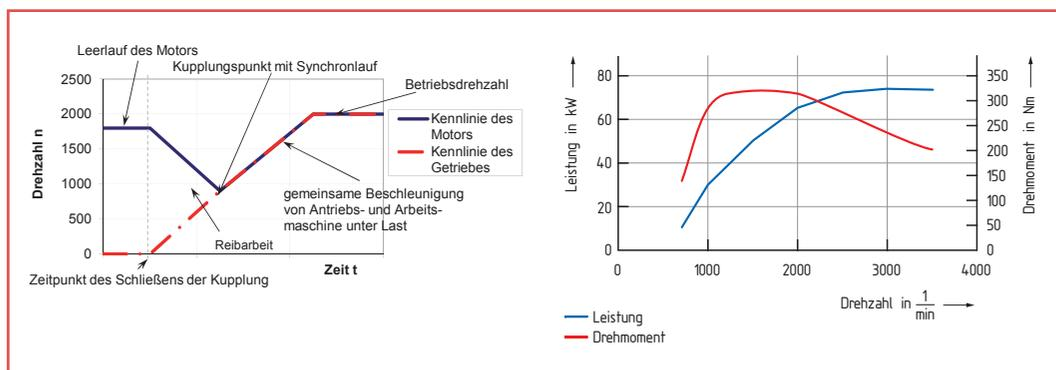
Bild 1 Einkuppelvorgang und Motordrehmoment
