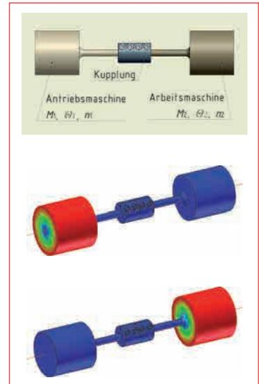
Bild 2 Elektromotor und Getriebe als gekuppelte Wellen mit Drehmassen als Zwei-Massen-Schwinger
