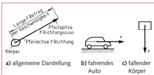
**Bild 1** Beispiele für die Vektordarstellung von Geschwindigkeiten unterschiedlicher Größe und Richtung
