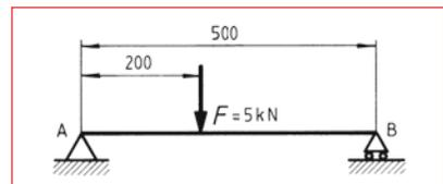
Bild 4 Stützträger mit Einzelkraft
