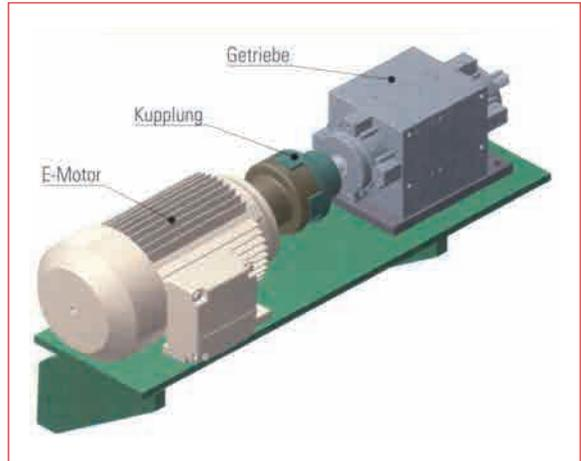
Bild 1 Aggregat aus Elektromotor, Kupplung und Arbeitsmaschine
