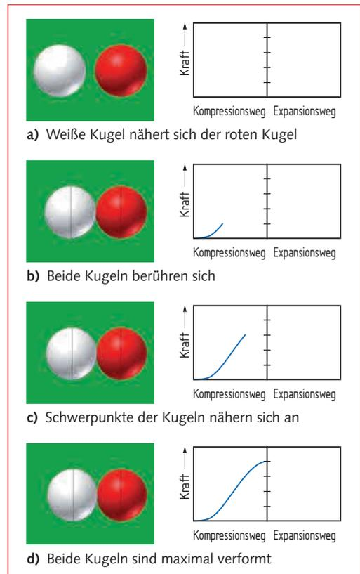
Bild 1 Stoß zweier Billardkugeln – Kompressionsphase
