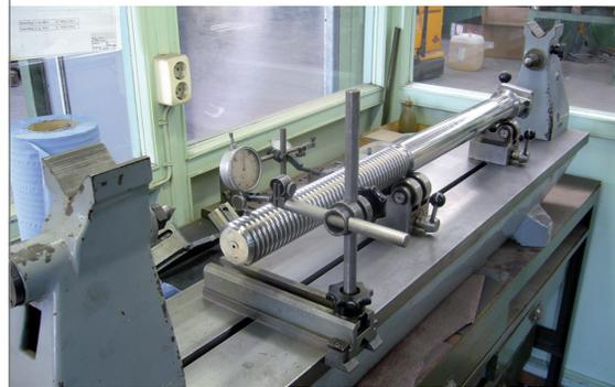
1 Rundlaufmessung an einer Spindel
