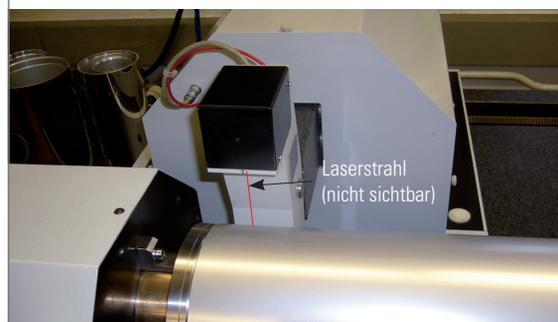
2 Rundheits-, Rundlauf-, Konizitäts- und Geradheitsmessung an einer Kopiertrommel mit Laser
