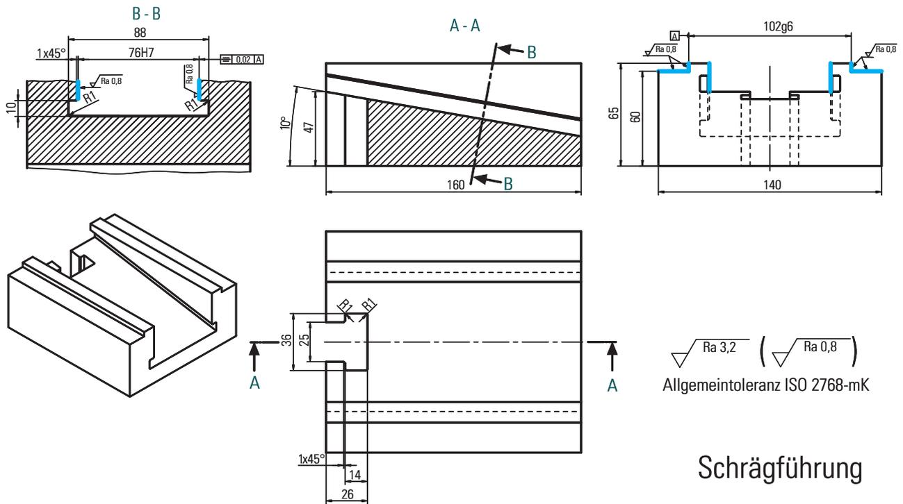
Die Schrägführung aus 30CrNiMo8 ist auf einer konventionellen Fräsmaschine mit spielfreien Vorschubantrieben zu fertigen. Dafür steht ein Rohling von 164x144x70 mm zur Verfügung.
