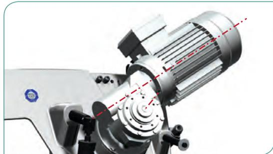
1 Antriebsmotor mit rechtwinklig angeordnetem Getriebe
