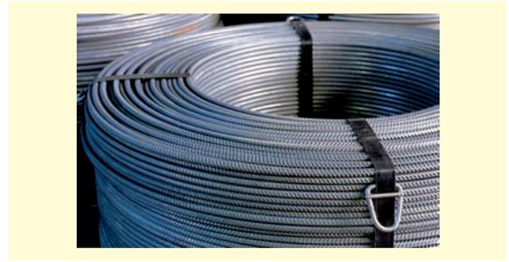
Betonstahl in Ringen B500A
