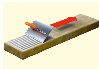
Vollflächiger Kleberauftrag auf Dämmplatte
