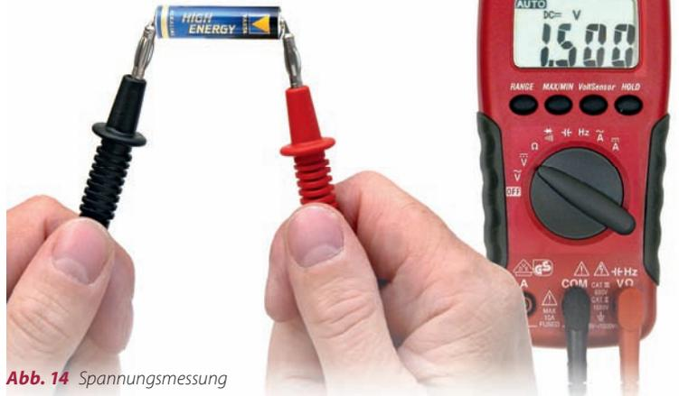
Abb. 14 Spannungsmessung
