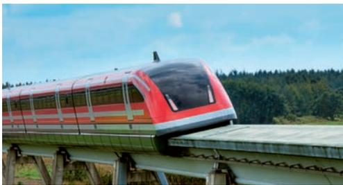
Abb. 3 Die magnetische Wirkung der Elektrizität lässt die Magnetschwebbahn schweben.
