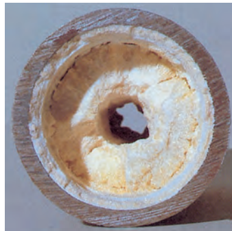
Abb. 19.2 Durch hartes Wasser verkrustete Heizschlange
