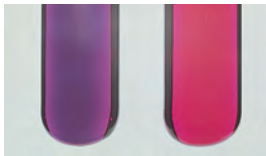
Abb. 8.1: Alkalische Reaktion: Lackmus wird blau, Phenolphthalein rot eingefärbt
