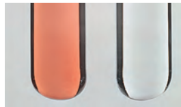
Abb. 8.2: Saure Reaktion: Lackmus rot, Phenolphthalein farblos
