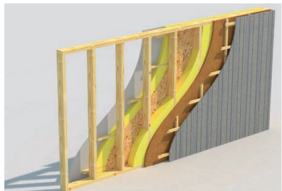
Wand in Holzrahmenbauweise
