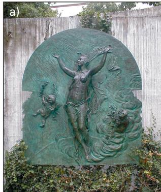
**Bild 2** Erwünschte Korrosion
