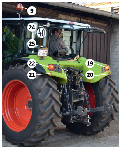
Abb. 1: Traktor/Schlepper – Beleuchtung und Signalanlage hinten
