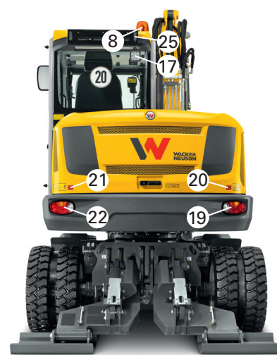
Abb. 2: Bagger – Beleuchtung und Signalanlage hinten
