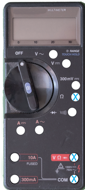
Abb. 2: Multimeter (als Ohmmeter) – Widerstandsmessung
