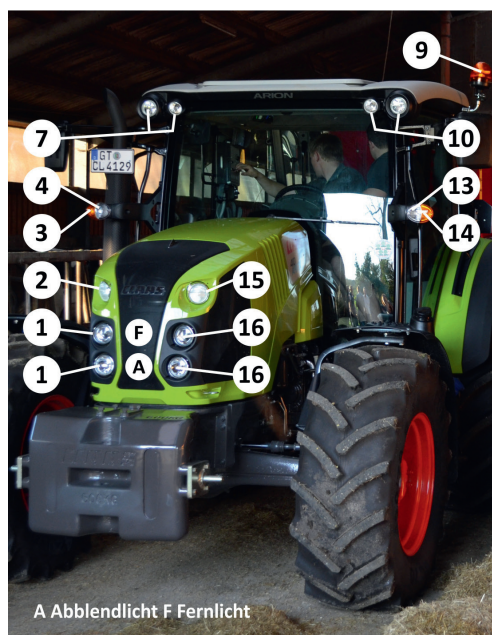
Abb. 1: Beleuchtungs- und Signalanlage Traktor/Schlepper – Vorn
